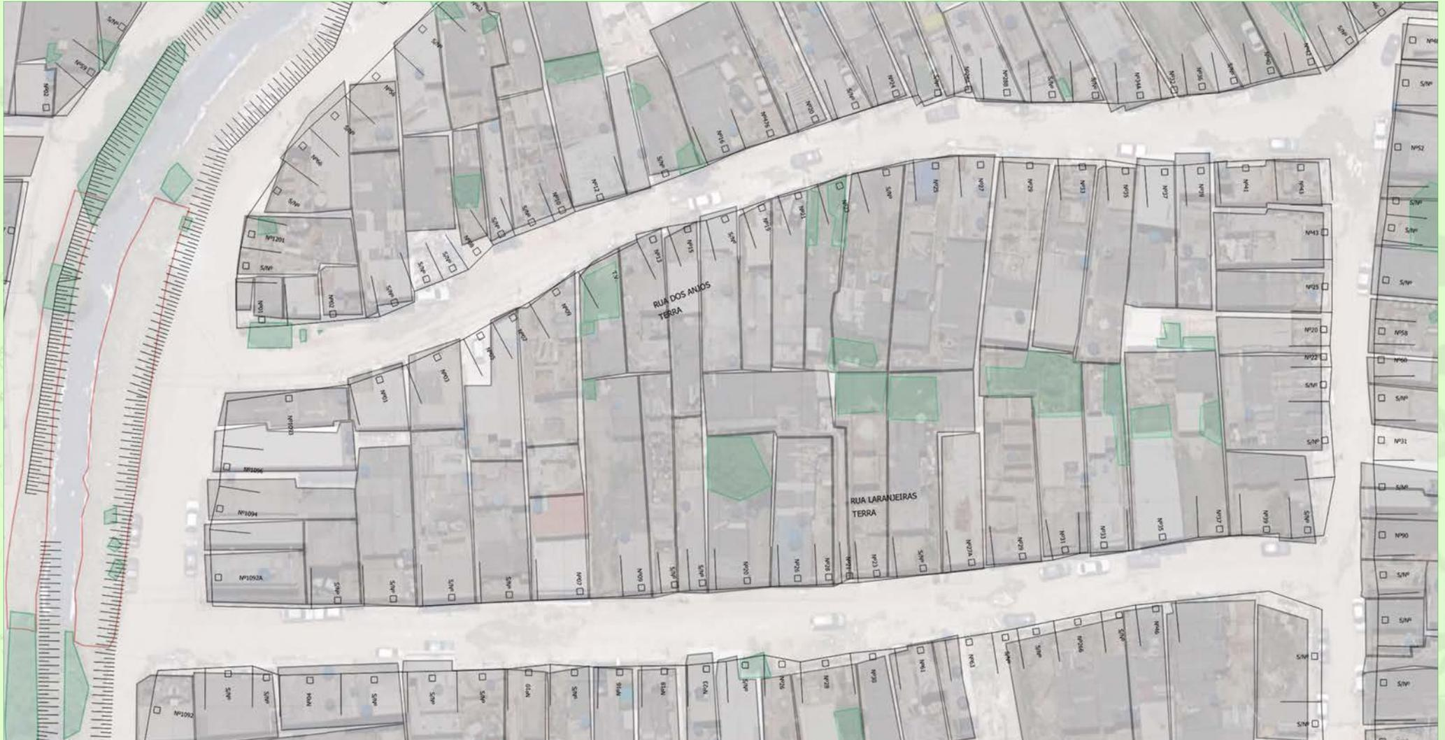
Mapeamento dos desníveis entre a rua e as moradias, pois as fundações das edificações apresentam uma variedade de alturas em relação à rua, o que impactará no planejamento da pavimentação. Identificação dos pontos de descarte das calhas, permitindo uma estimativa do volume de água vindo dos lotes, incidente no sistema de drenagem. A avaliação contribui para o cálculo do volume total de água a ser drenada pelas estruturas planejadas.
